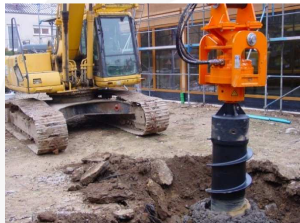
Abb. 3: Kopf und Hydraulikantrieb des Bohrers
